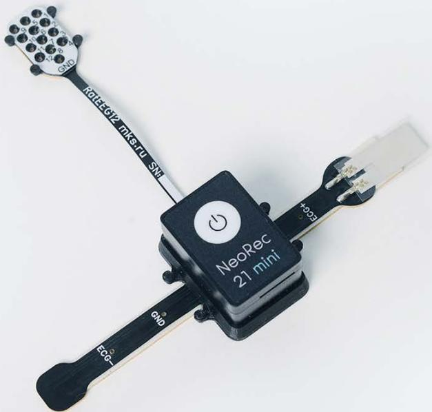
Мобильный ЭЭГ - усилитель постоянного тока NeoRec 21 mini предназначен для регистрации ЭЭГ и других биоэлектрических сигналов при проведении научных или медицинских исследований.
