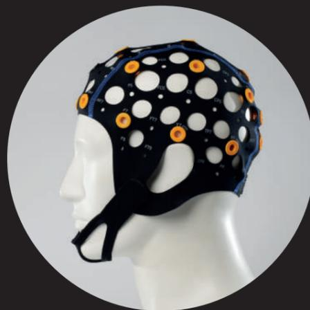
**12 размеров** шлемов MCScar соответствуют обхватам головы от 24 до 66 см, что даёт возможность подобрать соответствующий шлем для любого размера головы. Цвет шлема или шва помогает быстро определить нужный размер.
